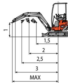
La capacità di sollevamento è basata sulla norma ISO 10567 e non eccede oltre il 75% del carico statico di ribaltamento o dell'87% della capacità di sollevamento idraulico della macchina.
